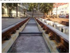
图 4 轨道试验台 Fig.4 Track test-bed
