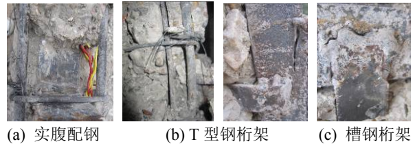
图 12 型钢骨架损伤照片
