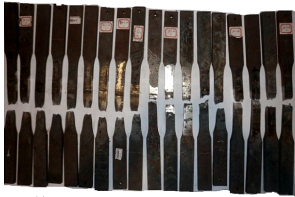
图 3 试件破坏模式图 Fig.3 Failure mode of the specimen
