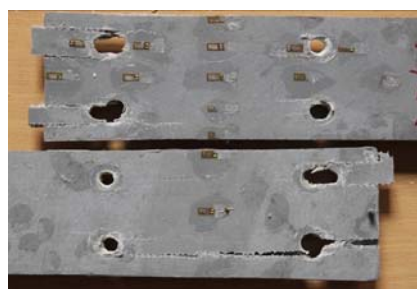
图 8 200L 和 250L 组破坏模式
