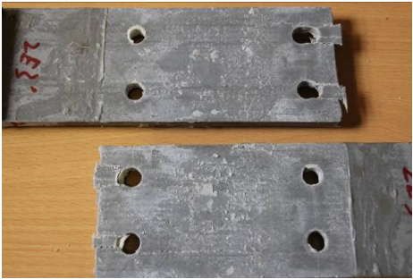
图 4 2E 组破坏模式 Fig.4 Failure mode of Group 2E
