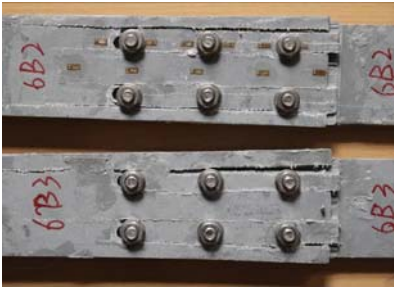
图10 6B和8B组破坏模式
