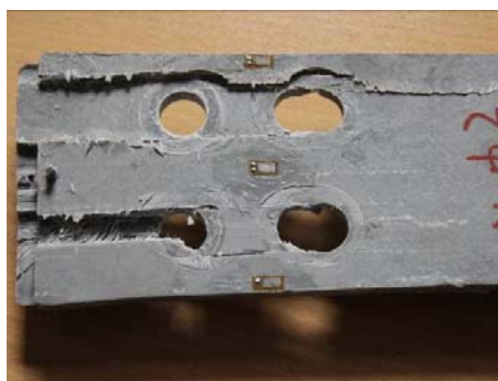
图 12 14D 组破坏模式
