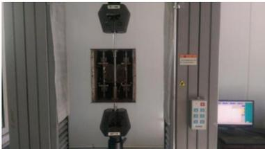
图 2 多维 SMA 阻尼器拉伸试验
