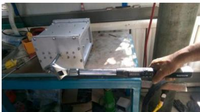
图 3 多维 SMA 阻尼器扭转试验
