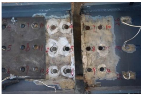
图 5 腹板上螺栓孔的变形
