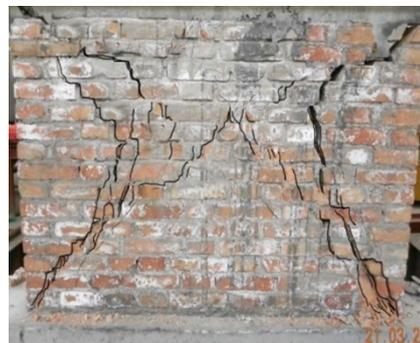
图 4 试件 W-1 破坏形态及裂缝分布情况
