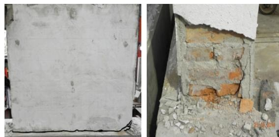
(a) 根部水平裂缝      (b) 墙体端部压碎
