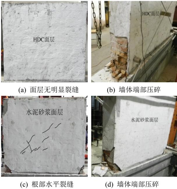
图 6 试件 HDCW-1 破坏形态及裂缝分布情况
