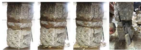
图 6 特种棱柱体典型试验过程照片
