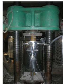
图 2 超低温冻融循环作用混凝土弹性模量试验装置
