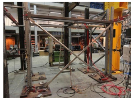
(a) 单层单跨带支撑钢货架结构试件 [50]
