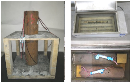
(a) 木质模具 (b) 养护水箱 图 1 试件制作与养护
