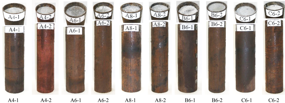
图4 推出后试件破坏形态
