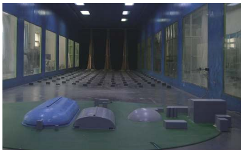
图1 条形封闭网架煤棚模型
