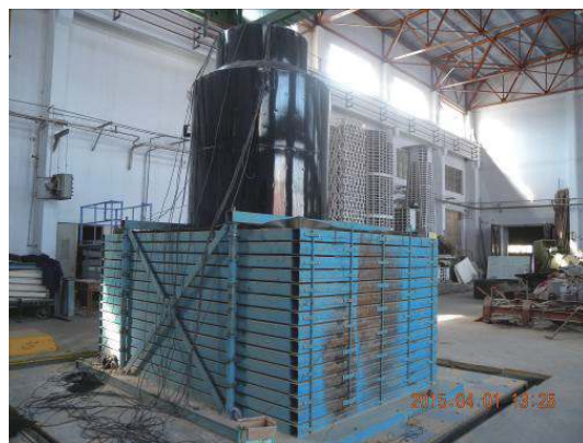
图1 核电厂土-结构相互作用模型振动台试验 Fig. 1 NPP shaking table test considering soil-structure interaction
