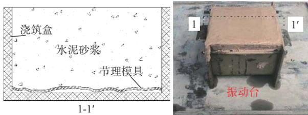
图3 人工节理的浇筑
