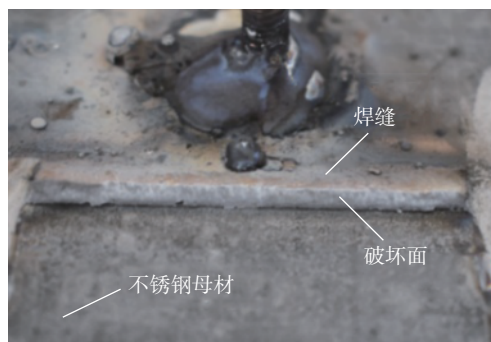
(a) 电弧焊正面角焊缝试件
