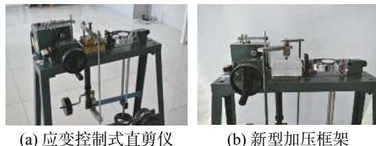
图 1 直剪仪与加压框架 Fig. 1 Shear instrument and pressurized frame
