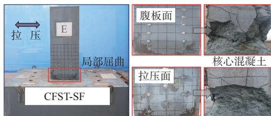
(b) 试件CFST-SF( $B=400$  mm), 网格尺寸 $50\text{ mm}\times 50\text{ mm}$
