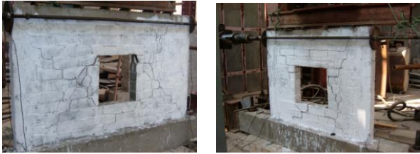
图6 W-1b、W-3b 墙片破坏时照片
