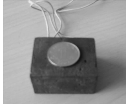
图 19 碳纤维混凝土传感器
