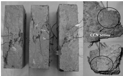
图 12 破坏后的 C40 混凝土柱及其内的 CCN 传感器
