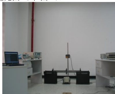
图 25 自主开发的三点弯曲梁混凝土测试装置
