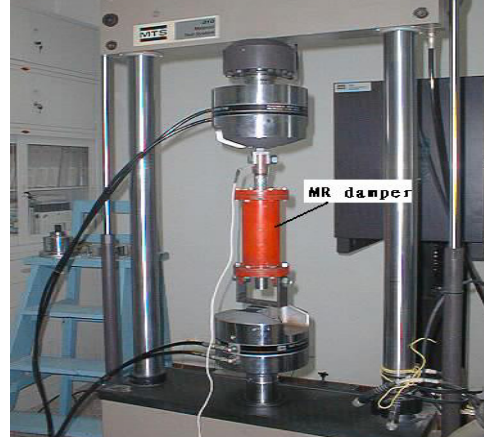
图 3 磁流变阻尼器实验图
