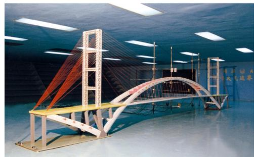
图 17 上海卢浦大桥全桥气弹模型
