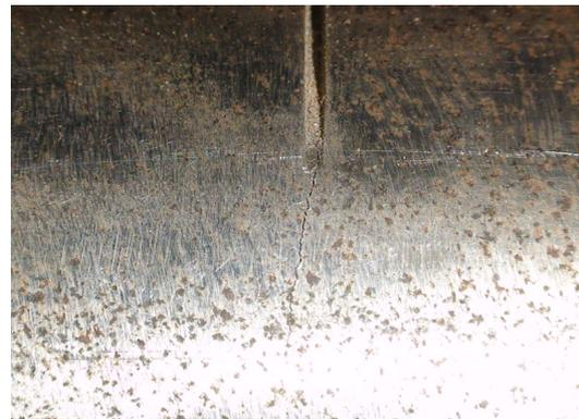
(a) 试验预制的疲劳裂纹
