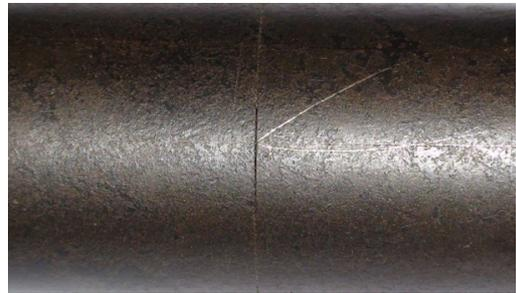
图 11 线切割裂纹
