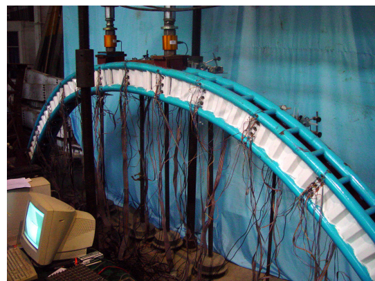
图 11 模型拱 ACSW-2 破坏照片 Fig.11 Failure mode of model arch ACSW-2
